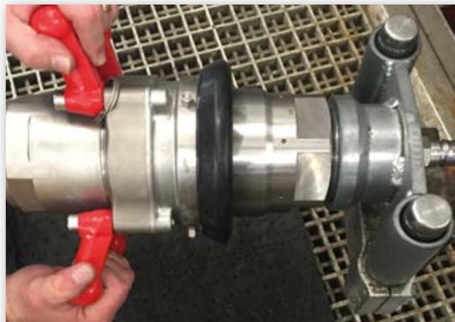
c) Wenn die Schlauchkupplung ordnungsgemäß gestützt ist, sollte diese leicht über den Adapter gleiten. Die drei Walzen rasten in den drei Öffnungen in einer von drei Positionen bei den Hauptpunkten mit 120 Grad ein.
