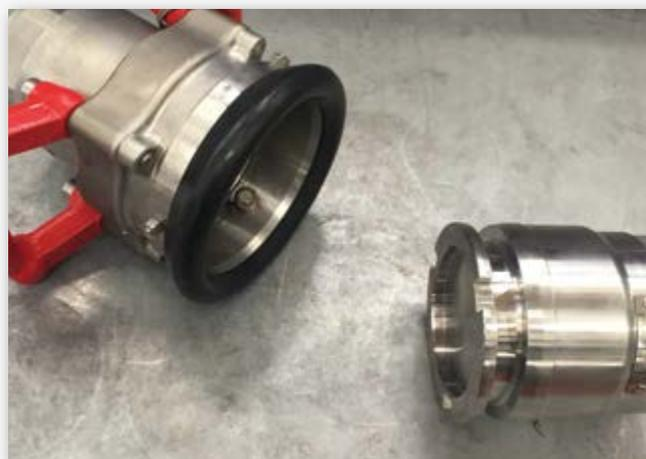
Damit die Kupplung leicht zum Adapter gerichtet werden kann und dabei gleichzeitig die Schlauchleitung stützt, sollte die Kupplung gedreht werden und vorsichtig in Richtung des Adapters geschoben werden. Sie merken, wie sich die Kupplung ca. 1" (25 mm) nach vorne bewegt.
